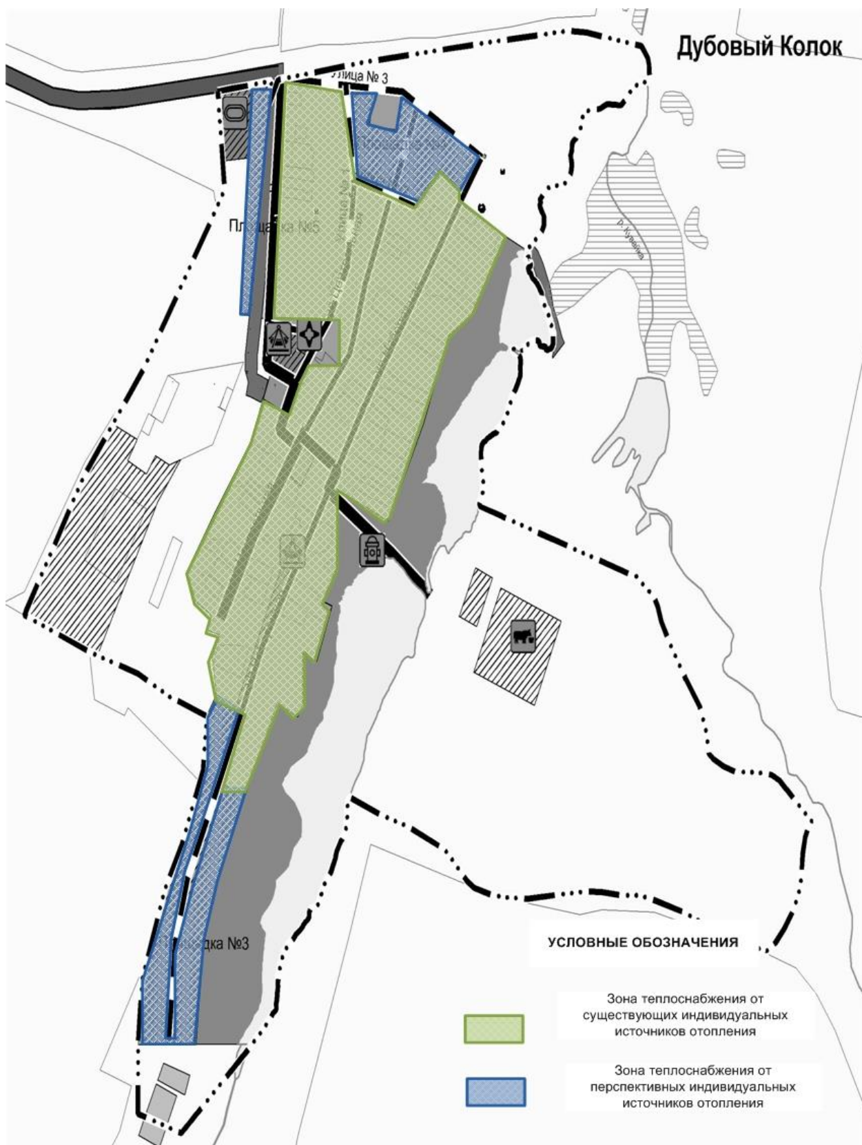
Рисунок 2.2.2 – Зоны действия систем индивидуального теплоснабжения п. Дубовый Колок
