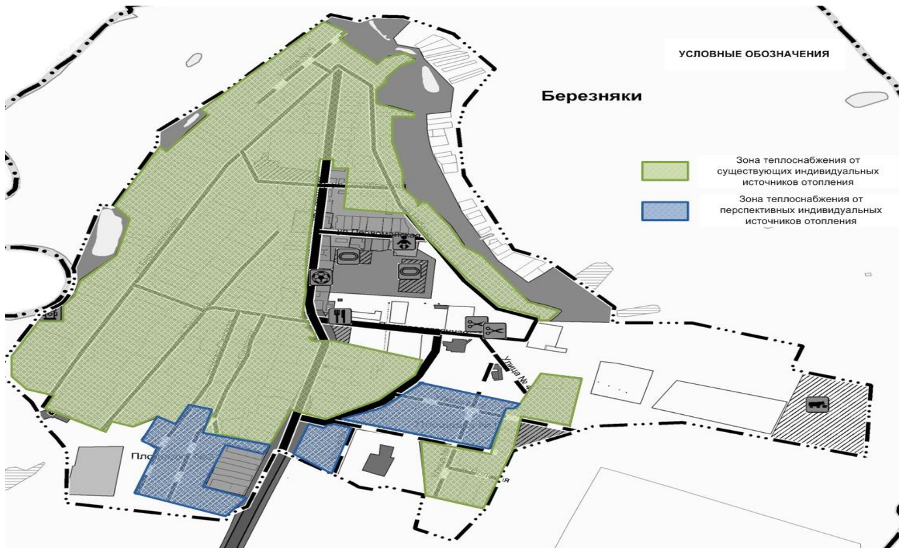
Рисунок 2.2.1 – Зоны действия систем индивидуального теплоснабжения с. Березняки
